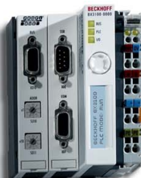
BX 系列总线端子模块控制器，集成 IEC 61131-3 PLC 和扩展接口
